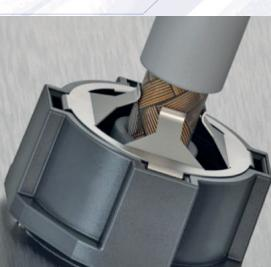
Le nouveau contre-écrou en polyamide avec un clip acier-inoxydable intégré pour contacter le blindage CEM de Wiska permet de protéger le CEM même avec entrée de câble en plastique. Le Wiska MagikNUT permet de réduire le coût des matériaux, d'assurer une grande flexibilité et d'effectuer un montage rapide. Il est en stock et disponible dans les diamètres M16, M20, M25 et les couleurs gris RAL 7035 et noir RAL 9005.
