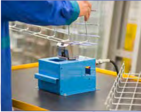
Bearbeitung von Gitterkanälen Machine processing of wire trays Usinage de caniveaux à grille
