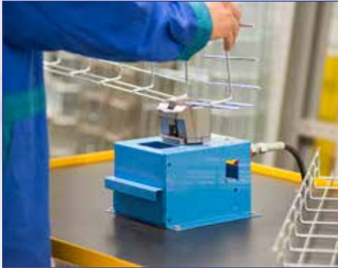
Bearbeitung von Gitterkanälen Machine processing of wire trays Usinage de caniveaux à grille
