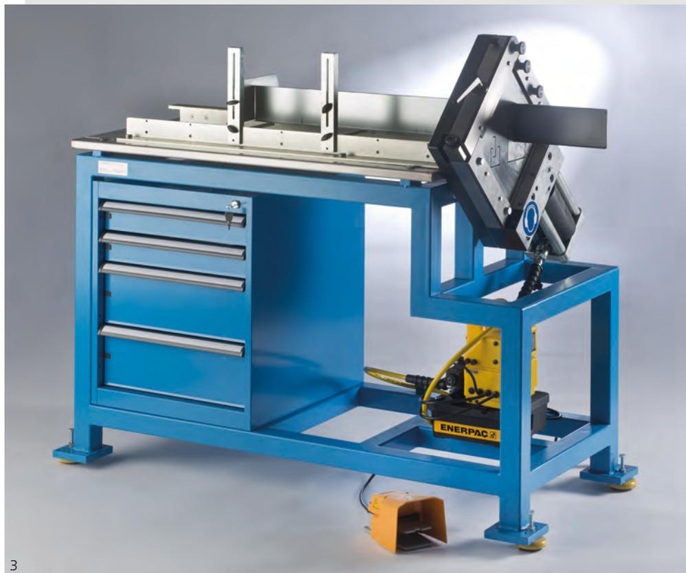
Abb. 1 – Einfaches Abtrennen mit der Gitter-Kanalschere MGKE M4
